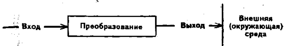
Рис. 3. Система типа «вход-выход»
